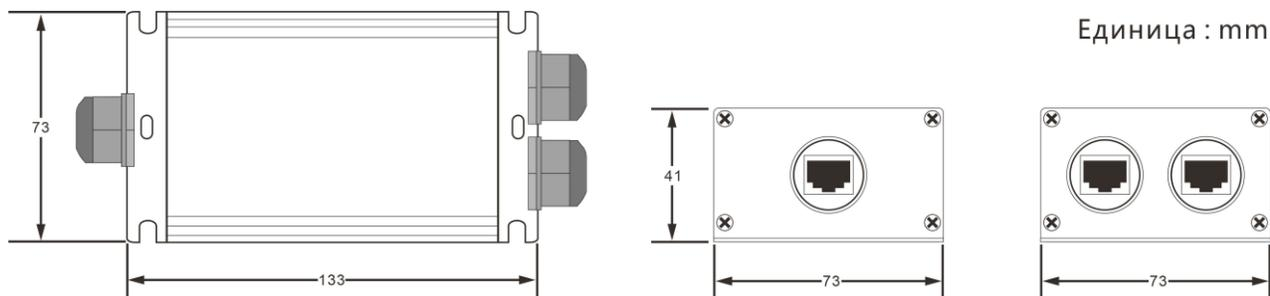
**Примечание:** Металлообрабатывающие детали допускают погрешность  $\pm 1$  мм.
