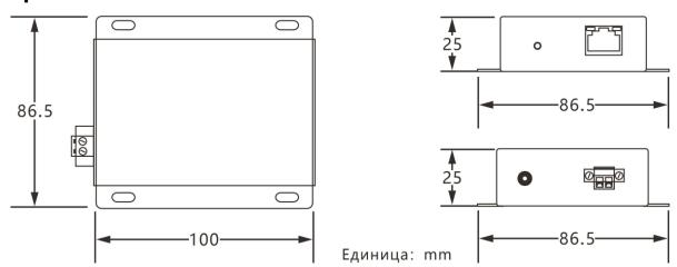
Примечание: Значение погрешности размера ±1 мм
