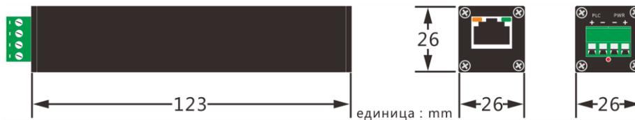
Внимание: Погрешность измерения в размерах  $\pm 1\text{mm}$
