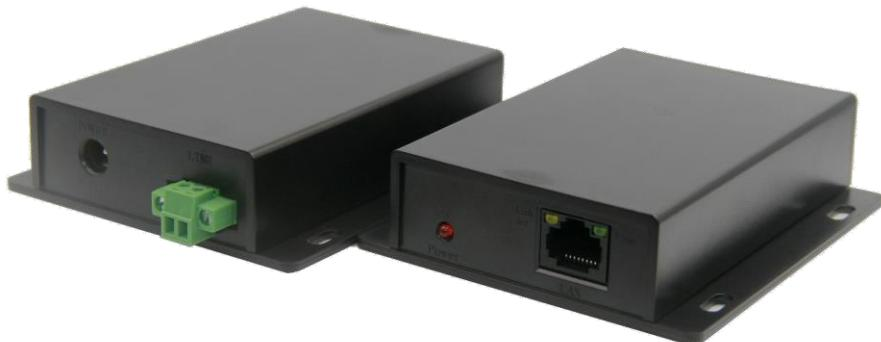
单口网络传输器为高速以太网信号传输设备。使用它可将网络信号通过两芯线，如双绞线、电话线、电源线等电缆进行长距离传输，传输距离可达 600 米，最大物理速率可以达到 500Mbps。
